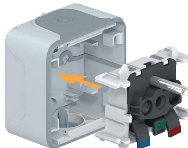
2/ Fixer le mécanisme par la face avant
